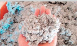
同社で採用する断熱工事は、外壁に厚さ25mmの発泡剤でできた断熱パネルを使用し、その内側にセルロースファイバー（写真）を170mmもの厚さで使い、家を二重の断熱材で覆う「ダブル断熱」。使用するセルロースファイバーは日本製のエコ断熱材。新聞紙を原料とするリサイクル素材なので、屋内配線を劣化させるアンモニアを含んでいないのが特徴。
